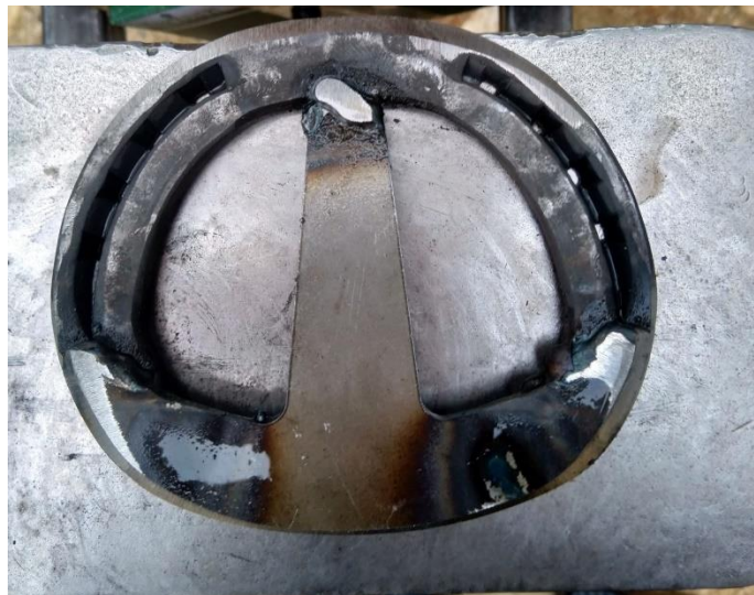
Forge d'une ferrure orthopédique
